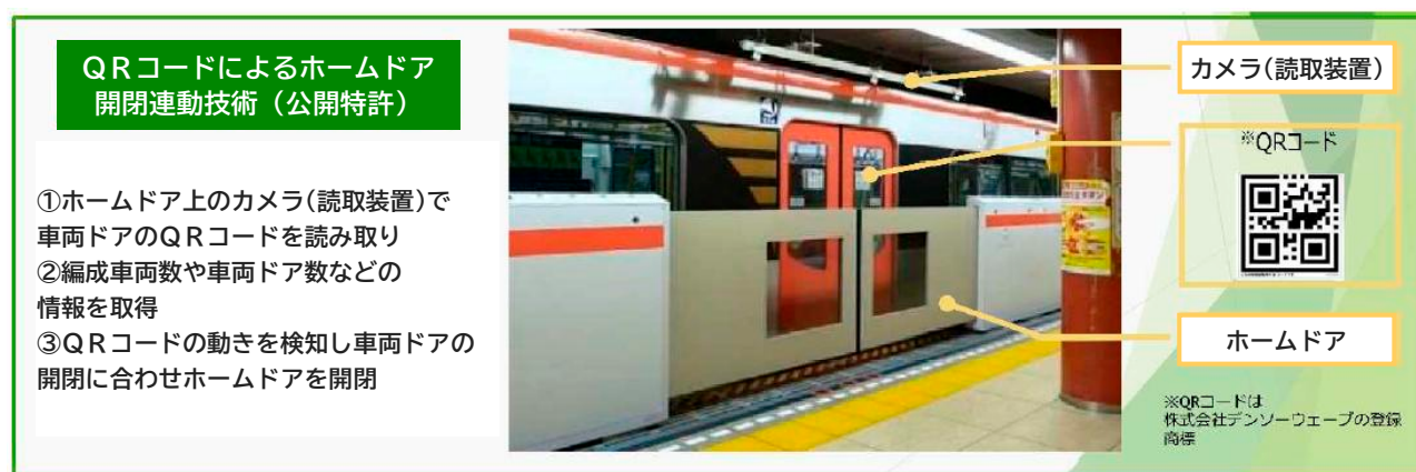
（図１）列車の扉位置に係る工夫事例（交通局によるＱＲコード開閉連携システムの導入）
